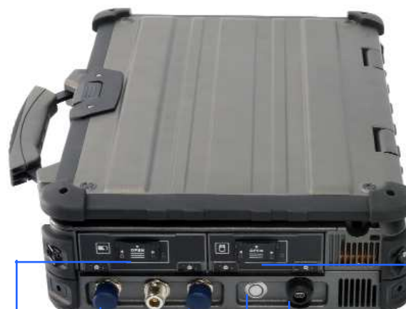
Batterie 8700mAh Entrée détecteur de puissance (max. 15dBm) Entrée HF de 50 ohms (N femelle, max. 20dBm) Sortie générateur de poursuite (max. 18dBm) Power USB Slave HDD
