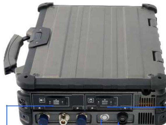
Batterie 8700mAh Entrée détecteur de puissance (max. 15dBm) Entrée HF de 50 ohms (N femelle, max. 20dBm) Sortie générateur de poursuite (max. 18dBm) Power USB Slave HDD
