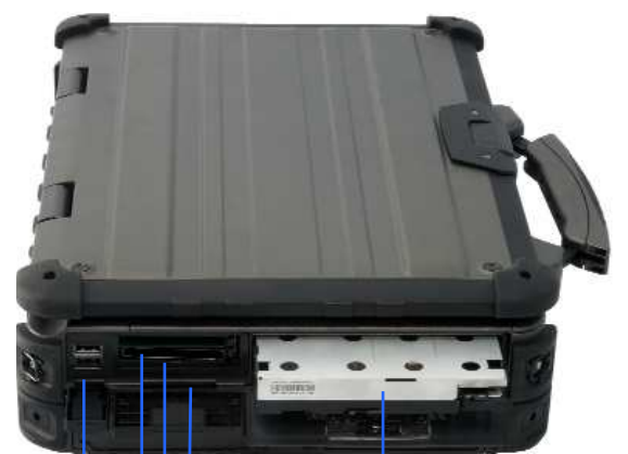
2x USB 3.0 Lecteur Smart Card ExpressCard PCMCIA-Slots Batterie Hot-Swap additionnelle ou DVD Multi Drive (optionnel)
