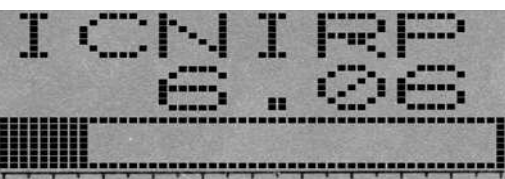
Le pourcentage atteint de la valeur limite s'affiche comme numéro décimal et comme barre graphique sur l'écran du SPECTRAN®
