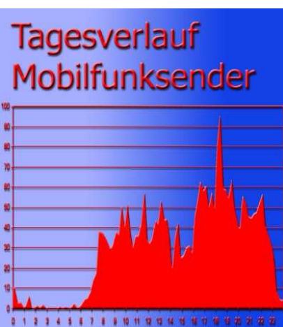
Diagramme qui affiche le changement du rayonnement d'un émetteur RF durant une journée. Relève des grandes fluctuations.
